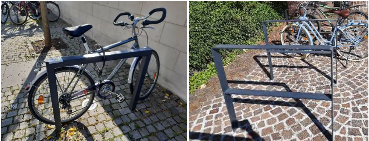
Abbildung 2-2: Einfacher Anlehnhalter mit Rahmenanschlussmöglichkeit am Bahnhofsplatz in Göppingen und mit zusätzlichem Knieholm am Marktplatz in Salach (Planungsbüro VIA 2023)
