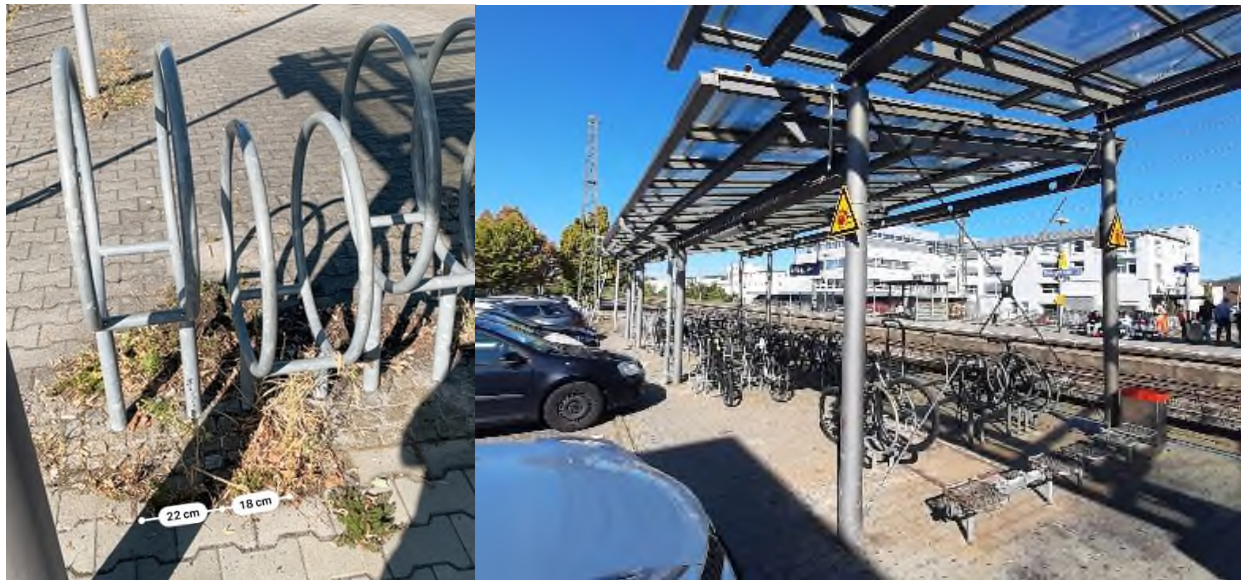
Abbildung 3-13: Anlehnhalter mit Vorderradanschlussmöglichkeit in Hoch-/Tief-Aufstellung in Eislingen/Fils (Quelle: Planungsbüro VIA 2023)
