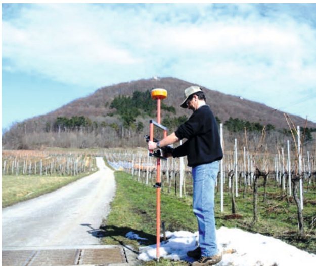
Flurbereinigung Beuren (Weinberge): Vermessung mit Satelliten im Rebgebiet.
